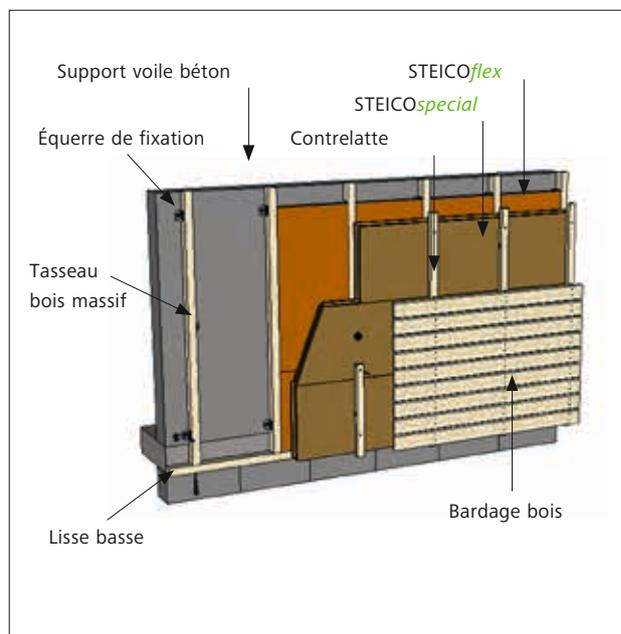
Le STEICO*flex* est ainsi soumis aux conditions normales d'exposition d'une structure à ossature bois. Cette mise en œuvre n'altère pas la durabilité normale du produit, du point de vue fongique comme physique.
